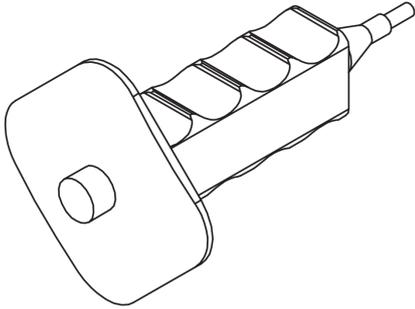
Der Einschlagdorn SA-D ermöglicht das schnelle, manuelle Setzen von Schlagankern SA. Die Herstellerangaben sind zwingend einzuhalten. Er besteht aus galvanisch verzinktem Stahl und ist in den Durchmessern 8, 10 und 12 mm verfügbar.
