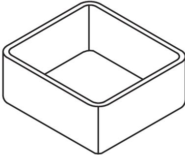
Die Schutzkappen SA 2 eignen sich für Schienen KHAL 41, KHA 42, KHA 41, A 41 und dienen der Abdeckung der Profilen. Sie sind kadmiumgelb als Hinweis für eventuelle Stoßstellen und bestehen aus Polyethylen. Für eine problemlose Montage der Schutzkappe ist ein Abstand von min. 50 mm zum Profile zu halten. Frei von Halogenen, Silikonen und sonstigen lackbenetzungsstörenden Zusätzen.
