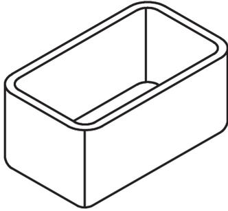
Die Schutzkappen SA 1 eignen sich für Schienen KHA 8, A 8, KHA 7, A 7, KHA 21 und dienen der Abdeckung der Profilenden. Sie sind kadmiumgelb als Hinweis für eventuelle Stoßstellen und bestehen aus Polyethylen. Für eine problemlose Montage der Schutzkappe ist ein Abstand von min. 50 mm zum Profilende einzuhalten. Frei von Halogenen, Silikonen und sonstigen lackbenetzungsstörenden Zusätzen.
