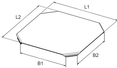
Die Installationskabelrinnen-Kreuzungsdeckel RIKDS eignen sich für Installationskabelrinnen-Kreuzungen RIK und schützen sie vor Schmutz und Feuchtigkeit. Sie rasten formschlüssig auf den Seitenholmen ein. Sollen die Deckel im Freien eingesetzt werden, sind zusätzliche Sicherungswinkel gegen Windeinflüsse nötig. Der Deckel besteht aus sendzimir-feuerverzinktem Stahl.
