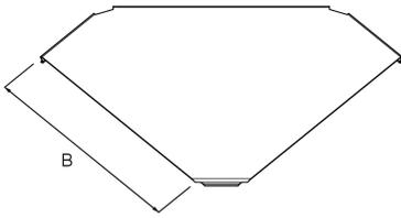
Die schweren Installationskabelrinnen-Bogen-Deckel RIBDS 90° eignen sich für Installationskabelrinnen-Bögen RIB 90° und schützen sie vor Schmutz und Feuchtigkeit. Sie rasten formschlüssig auf den Seitenholmen ein. Sollen die Deckel im Freien eingesetzt werden, sind zusätzliche Sicherungswinkel gegen Windeinflüsse nötig. Der Deckel besteht aus sendzimir-feuerverzinktem Stahl.
