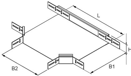
Der Installationskabelrinnen-Abzweig RIA 60 ermöglicht die horizontale Richtungsänderung der Kabelführung in Form eines Abzweigs. Dieser wird zwischen zwei Kabelrinnen eingesetzt und ermöglicht den Anschluss einer weiteren Kabelrinne im rechten Winkel. Der Kabelrinnen-Abzweig eignet sich für Installationskabelrinnen mit einer Seitenhöhe von 60 mm und besteht aus sendzimir-feuerverzinktem Stahl.
