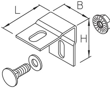
Der Sturmsicherungswinkel RD-SW dient der zusätzlichen Sicherung der Kabelrinnen-Deckel bei Verwendung im Außenbereich. Er wird aufgesetzt und verschraubt. Das notwendige Befestigungsset ist enthalten. Es sind mindestens 6 Sicherungselemente pro 3 Meter Kabelbahndeckel gemäß der Montageanleitung zu verwenden. Verschiedene Materialien und Oberflächen sorgen dafür, dass die Korrosionsanforderungen unterschiedlichster Anwendungsgebiete erfüllt werden.
