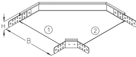
Die Kabelrinnen-Bögen RB 35 ermöglichen horizontale Richtungsänderungen der Kabelführung um 90°. Sie eignen sich für Kabelrinnen mit Seitenhöhen von 35 mm und verfügen über integrierte Seitenverbinder. Mithilfe eines Bodenverbinders VB wird der Bogen in die Kabelrinne eingeschoben und verschraubt. Verschiedene Materialien und Oberflächen sorgen dafür, dass die Korrosionsanforderungen unterschiedlichster Anwendungsgebiete erfüllt werden.
