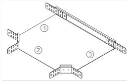
Der Kabelrinnen-Abzweig RA 60 ermöglicht horizontale Richtungsänderungen der Kabelführung in Form eines Abzweigs. Er wird zwischen zwei Kabelrinnen eingesetzt und ermöglicht den Anschluss einer weiteren Kabelrinne im rechten Winkel. Der Kabelrinnen-Abzweig eignet sich für Kabelrinnen mit Seitenhöhen von 60 mm. Verschiedene Materialien und Oberflächen sorgen dafür, dass die Korrosionsanforderungen unterschiedlichster Anwendungsgebiete erfüllt werden.
