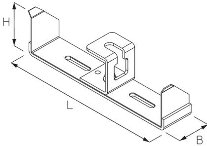
Die innenliegende Mittelabhängung MA 60 dient der Deckenabhängung von Kabelrinnen mit einer Breite bis 300 mm. Sie ist für Lasten bis 0,26 kN vorgesehen und besteht aus sendzimir-feuerverzinktem Stahl. MA 60 muss von den Seiten der Kabelrinne eingeschoben werden. Die Abhängung erfolgt mit einem Gewindestab GB (nicht im Set enthalten).
