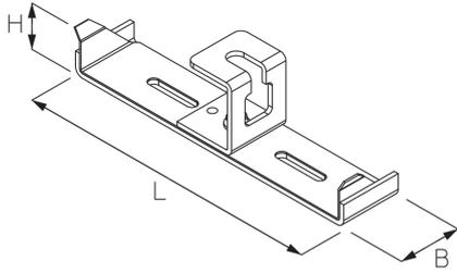
Die innenliegende Mittelabhängung MA 35 dient der Deckenabhängung von Kabelrinnen mit einer Breite bis 300 mm. Sie ist für Lasten bis 0,26 kN vorgesehen und besteht aus sendzimir-feuerverzinktem Stahl. MA 35 muss von den Seiten der Kabelrinne eingeschoben werden. Die Abhängung erfolgt mit einem Gewindestab GB (nicht im Set enthalten).
