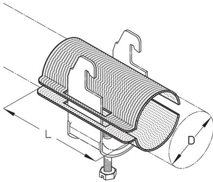
Die Langwanne LW dient der verbesserten Kabelaufgabe. Sie eignet sich für Kabel mit einem Durchmesser bis max. 120 mm und steht in Längen von 70 bzw. 100 mm zur Verfügung. Verschiedene Materialien und Oberflächen sorgen dafür, dass entsprechende Anforderungen an unterschiedliche Anwendungsbereiche erfüllt werden.
