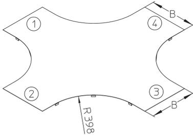
Die Kabelleiter-Kreuzung-Deckel LKD eignen sich für Kabelleiter-Kreuzungen und schützen sie vor äußeren Einflüssen wie Schmutz und Feuchtigkeit. Sie werden auf den Kreuzungen aufgesetzt. Sollen die Deckel im Freien eingesetzt werden, sind zusätzliche Sicherungswinkel gegen Windeinflüsse nötig. Verschiedene Materialien und Oberflächen sorgen dafür, dass die Korrosionsanforderungen unterschiedlichster Anwendungsgebiete erfüllt werden.
