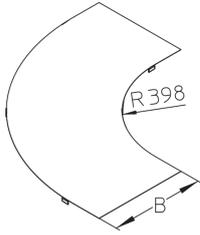
Die Kabelleiter-Innenbogen-Deckel LIBD eignen sich für Kabelleiter-Innenbögen und schützen sie vor äußeren Einflüssen wie Schmutz und Feuchtigkeit. Sie werden auf den Bögen aufgesetzt. Sollen die Deckel im Freien eingesetzt werden, sind zusätzliche Sicherungswinkel gegen Windeinflüsse nötig. Verschiedene Materialien und Oberflächen sorgen dafür, dass die Korrosionsanforderungen unterschiedlichster Anwendungsgebiete erfüllt werden.
