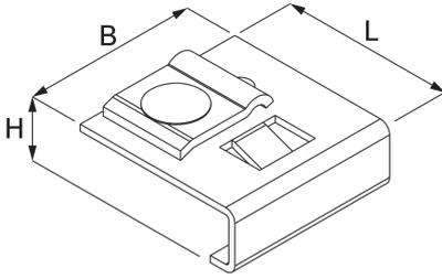
Kabelleiter-Verbinder T-Stoß oben LGVTO dient zur Herstellung einer Abzweigung von höhenversetzten Kabelleitern LGG. Der Verbinder wird im 45° Winkel auf das Holmprofil der Kabelleiter LGG gesteckt und heruntergeklappt. Mit den beigelieferten Klemmbefestigungen KLU wird die Kabelleiter LGG befestigt. Verschiedene Materialien und Oberflächen sorgen dafür, dass die Korrosionsanforderungen unterschiedlichster Anwendungsgebiete erfüllt werden.
