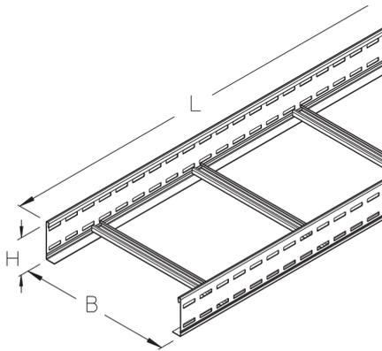
Die gelochten und geschweißten Kabelleitern LGGS 100 schwerer Ausführung haben eine Holmhöhe von 100 mm und sind in Bahnbreiten von 200 bis 600 mm sowie in einer Länge von 3000 und 6000 mm erhältlich. Die Sprossen bestehen aus Profilschienen (30 x 15 mm). Verschiedene Materialien und Oberflächen sorgen dafür, dass die Korrosionsanforderungen unterschiedlichster Anwendungsgebiete erfüllt werden.
