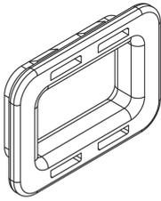
Die Kabelschutzringe KSR 35 aus Polyethylen eignen sich für die gelochten, löschwasserdurchlässigen Kabelrinnen RGL 60. Sie können in die Löcher der Kabelrinnen gesetzt werden und dienen dem Schutz der hindurchgeführten Kabel und Leitungen.
