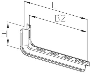
Die Stielkonsole KSL wird am Konsolhalter KDSL befestigt und ist für maximale Lasten bis 1,3 kN vorgesehen. Sie besteht aus einem mittig gelochten W-/Trapezprofil 60 x 20 mm. Verschiedene Materialien und Oberflächen sorgen dafür, dass die Korrosionsanforderungen unterschiedlichster Anwendungsgebiete erfüllt werden. FD/P: Faktor zur Berechnung der Dübellast FD mit tatsächlicher Konsollast P bzw. Summe tatsächlicher Konsollasten.
