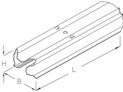
Der KPR-Verbinder KPV dient der Verbindung zweier Lichtbandhalteschienen KPR. Er wird in die erste Schiene eingeschoben. Anschließend wird die Anschlusschiene auf den Verbinder geschoben. Er steht in einer Länge von 300 mm zur Verfügung und besteht aus sendzimir-feuerverzinktem Stahl.
