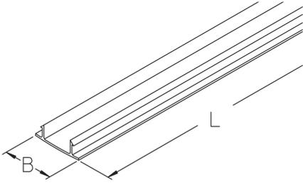
Damit elektrische Leitungen in Bereichen ohne Leuchte nicht herausfallen, schließt die Deckleiste KPD die Lichtbandhalteschiene KPR nach unten hin ab. Sie steht wie die Schienen in Längen von 3000 und 6000 mm zur Verfügung und besteht aus Polyvinylchlorid in der Farbe Eisengrau.
