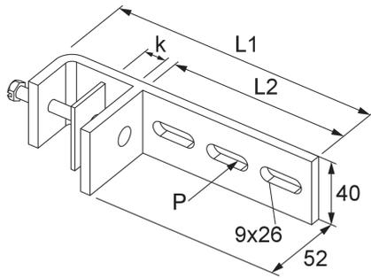
Die geschweißte Klemmbefestigung KLUGS dient der Fixierung von Gitterbahnen und Kabelrinnen an senkrecht verlaufenden Stahlträgern. Das zu verwendende Anzugsdrehmoment beträgt 10 Nm. Der Klemmbereich erstreckt sich von 5 - 33 mm. Verschiedene Materialien und Oberflächen sorgen dafür, dass die Korrosionsschutzanforderungen unterschiedlichster Anwendungsgebiete erfüllt werden.
