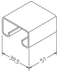
Durch den Einsatz des Stützstücks KHUSS 57 im Konsolhalter KDU/KHU 57 können die maximalen Tragfähigkeiten erreicht werden. Verschiedene Materialien und Oberflächen sorgen dafür, dass die Korrosionsanforderungen unterschiedlichster Anwendungsgebiete erfüllt werden.
