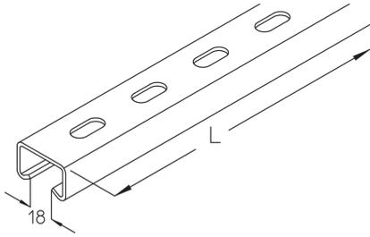
Die Profilschiene KHA 9 besteht aus einem C++-Profil 39,5 x 25 mm mit fortlaufender Lochung und einer Schlitzweite von 18 mm (Materialstärke = 2,75 mm). Sie steht in tauchfeuerverzinktem Stahl zur Verfügung und ist in den Längen 200 bis 6000 mm lieferbar.
