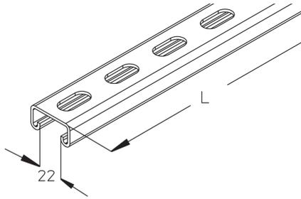
Die Montageschiene KHA 21 besteht aus einem G+-Profil 41 x 21 mm mit fortlaufender Lochung und einer Schlitzweite von 22 mm sowie einer Materialstärke von 2,5 mm. Verschiedene Materialien und Oberflächen sorgen dafür, dass die Korrosionsanforderungen unterschiedlichster Anwendungsgebiete erfüllt werden. Sie ist in Längen bis 6000 mm lieferbar.
