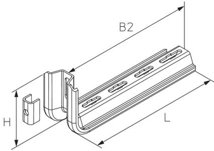
Der Konsolhalter KDSL ist zusammen mit der Konsole KSL für leichte Lasten ausgelegt. Er besteht aus einem mittig gelochten W-/Trapezprofil 60 x 20 mm. Verschiedene Materialien und Oberflächen sorgen dafür, dass die Korrosionsanforderungen unterschiedlichster Anwendungsgebiete erfüllt werden. Die Montage des Zwischenstücks KSL-SP ist erforderlich, um Verformungen des Profils durch Vorspannkraft des Befestigungselements zu vermeiden.
