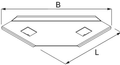
Das T-Stoß-Verbinder-Blech seitlich KATBS dient dem Kabelschutz an nicht ausgeschnittenen T-Verbindungen von RG, LGG und WPL/WPR, um eine kabelschonende Verlegung zu ermöglichen. Hiermit werden Leitungen ohne scharfe Kanten über den Holm des Kabeltragsystems geführt. Das Blech wird auf den Holm gelegt und mit Sechskantschraube(n) SES verschraubt.
