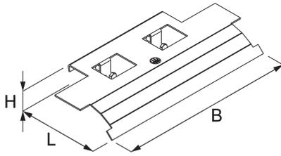
Das T-Stoß-Verbinder-Blech dient dem Kabelschutz an nicht ausgeschnittenen T-Verbindungen von RG, LGG und WPL/WPR, um eine kabelschonende Verlegung zu ermöglichen. Hiermit werden Leitungen ohne scharfe Kanten über den Holm des Kabeltragsystems geführt. Das Blech wird auf den Holm gelegt und mit Sechskantschraube(n) SES verschraubt.
