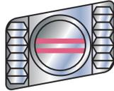
JXD M12 besitzen die Allgemeine bauaufsichtliche Zulassung Z-21.4-1690. Sie werden in Verbindung mit den gezahnten Anker- und Montageschienen W 29/20 eingesetzt und aus feuerverzinktem Stahl, galvanisch verzinktem Stahl oder aus Edelstahl gefertigt. Ein weiteres Merkmal der Schrauben sind die zwei Kerben an ihrem Schaftende. Die JXD M12 sind in verschiedenen Längen erhältlich. Die Lieferung erfolgt inklusive Muttern.
