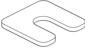
Die Vierkantschlitzscheibe JVS aus Edelstahl (A4) ist Bestandteil des Sets für den Brüstungsanker JBA, kann aber auch einzeln bestellt werden. Zusammen mit der Vierkantlochscheibe JVL dient sie zur Unterfütterung und ermöglicht so ein Anheben des Brüstungsankers JBA am Zuglager. Durch den Schlitz ist eine einfache Montage und Demontage möglich. Die Vierkantschlitzscheiben JVS sind in verschiedenen Größen erhältlich.
