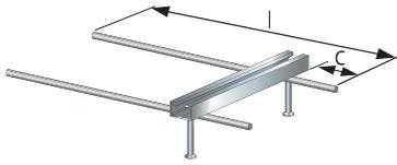
Die Ankerschiene JTA RT W 55/42 wird aus feuerverzinktem Stahl (fv) oder Edelstahl (A4) hergestellt. Die JTA RT W 55/42 verfügt über Rundanker und Bewehrungsstäbe aus Betonstahl. Sie ist in Profillängen von 150 bis 550 mm sowie in mehreren Varianten für die Betonabdeckung erhältlich und wird mit den Schrauben JB M16 - JB M24 gepaart. Die Füllung ist aus Polyethylen (PE).
