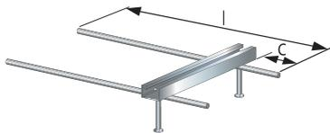
Die Ankerschiene JTA RT W 40/22 wird aus feuerverzinktem Stahl (fv) oder Edelstahl (A4) hergestellt. Die JTA RT W 40/22 verfügt über Rundanker und Bewehrungsstäbe aus Betonstahl. Sie ist in Profillängen von 150 bis 550 mm sowie in mehreren Varianten für die Betonabdeckung erhältlich und wird mit den Schrauben JC M10 - JC M16 gepaart. Die Füllung ist aus Polyethylen (PE).
