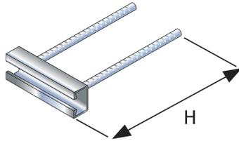
Die Ankerschiene JTA RF W 50/30 wird aus feuerverzinktem Stahl (fv) oder Edelstahl (A4) hergestellt. Die JTA RF W 50/30 verfügt über Bewehrungsstäbe als Anker aus Betonstahl. Sie ist in Profillängen von 150 bis 350 mm erhältlich und wird mit den Schrauben JB M10 - JB M20 gepaart. Die Füllung ist aus Polyethylen (PE).
