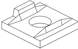
Kerbzahnscheiben JKZS gewährleisten rutschhemmende Schraubverbindungen in Langlöchern. Durch zwei Kerbzähne auf der Unterseite der Scheibe wird eine kraftschlüssige Verbindung bis 7,5 kN bei 3-facher Sicherheit ermöglicht. Gleichzeitig bietet die Kerbzahnscheibe den Vorteil des Toleranzausgleichs im Langloch. Sie ist aus feuerverzinktem Stahl gefertigt und geeignet für Schrauben M16.
