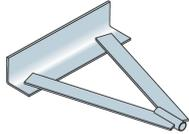
Der Gerüstanker JGA+ Q sichert Arbeitsgerüste am fertigen Bauwerk, ohne die Verblenderschale zu beschädigen. Er wird an der tragenden Konstruktion mit Dübeln befestigt und in der T-Fuge durch die Verblenderschale geführt. Außenwerbung oder später benötigte Gerüste, die freistehend nicht standsicher sind, können an den Gerüstankern befestigt werden. Der JGA+ Q besteht aus Edelstahl A4 und weist eine Tragfähigkeit NRd von 8,6 auf. Er ist in mehreren Längen verfügbar.
