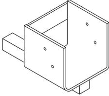
Der Gerüstschuh JG-H ist Bauart geprüft mit dem TÜV-Zertifikat R 60085529. Er wird aus Stahl hergestellt. Der Gerüstschuh weist einen der Laststufe entsprechenden farbigen Korrosionsschutzanstrich auf. Seine Tragfähigkeit VRd beträgt je nach Typ 4,2 bis 18,5 kN. In der Regel ist er für Kantholzbreiten von 100 mm ausgelegt. Auf Anfrage sind auch Breiten von 120 mm möglich.
