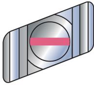
JC M16 besitzen die Europäische Technische Bewertung ETA-09/0338. Sie finden ihre Anwendung bei der Befestigung von Anschlusskonstruktionen an Anker- und Montageschienen W 40+, W 40/22, K 40/22 und K 40/25. Die Schrauben sind durch eine Hakenkopfform und eine Kerbe am Schaftende gekennzeichnet. Sie werden aus feuerverzinktem Stahl, galvanisch verzinktem Stahl oder aus Edelstahl gefertigt. Die JC M16 sind in verschiedenen Längen erhältlich. Sie werden inklusive Muttern geliefert.
