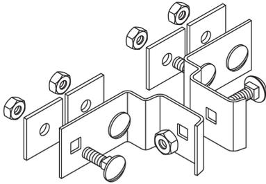
Der Befestigungswinkel HKIQ eignet sich zur Verbindung zweier Konsolhalter KHI in einem Winkel von 90°. (Anwendungsbild beachten). Verschiedene Oberflächen sorgen dafür, dass die Korrosionsanforderungen unterschiedlichster Anwendungsgebiete erfüllt werden.
