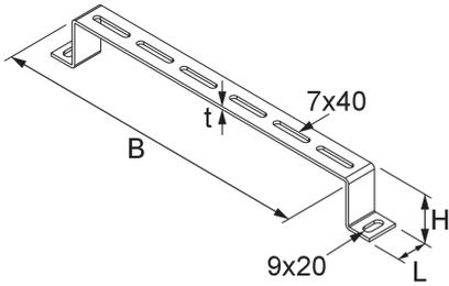
Mithilfe des Distanzbügels HB 50 lassen sich gelochte Kabelrinnen und Gitterbahnen mit Abstand auf dem Boden oder an der Wand montieren. Die Befestigung erfolgt mit GH 6x24 oder KLU, bzw. mit KLF oder KLR.
