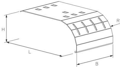
Das Gitterbahn-Abgangsblech GKAB unterstützt die Einhaltung von erforderlichen Biegeradien bei der vertikalen Ausführung von Kabeln und Leitungen. Es wird mit zwei Klemmbefestigungen KLU an der Gitterbahn montiert. Der Abstand der Längsdrähte der Gitterbahn spielt bei der Montage keine Rolle, allerdings sollte der Abstand der Querdrähte mind. 94 mm betragen. Das Gitterbahn-Abgangsblech GKAB besteht aus sendzimir-feuerverzinktem Stahl.
