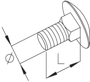
Die Flachrundschraube mit Vierkant FRSS gemäß DIN 603 hat einen Durchmesser von 6 mm, eine Länge von 12 mm und besteht aus galvanisch verzinktem Stahl. Sie dient der Befestigung von Bodenkanal-Drehriegeln (DR-BK).
