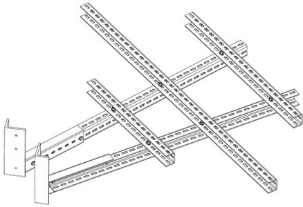
Die Eckbefestigung EBW ist für maximale Lasten bis 6,50 kN vorgesehen. Sie wird an Betonstützen gedübelt und dient der Befestigung von Weitspann-Formteilen wie Bögen, die eine horizontale Richtungsänderung bis 90° ermöglichen. Die Eckbefestigung eignet sich für Formteile und Kabelbahnen mit einer Breite von 200 bis 600 mm und besteht aus tauchfeuerverzinktem Stahl.
