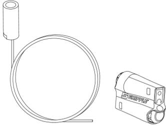
Die Seilabhängung DSAXPET8 2 mit M8-Gewindeübergang und Expressverschluss dient der Deckenabhängung von Kabelrinnen und Gitterbahnen. Sie besteht aus galvanisch verzinktem Stahl und ist in Längen von 1000 bis 10000 mm verfügbar. Die maximale Belastung liegt bei 0,44 kN (Grippe Lastklasse 2).
