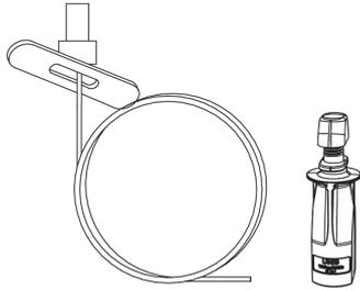
Die Seilabhängung DSAUGSP 2 mit Queranker und UniGrip-Standardverschluss dient der Deckenabhängung von Kabelrinnen und Gitterbahnen. Sie besteht aus galvanisch verzinktem Stahl und ist in Längen von 1000 bis 10000 mm verfügbar. Die maximale Belastung liegt bei 0,54 kN (Grippe Lastklasse 2).
