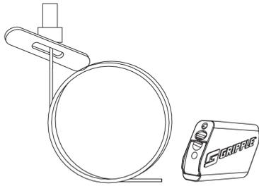
Die Seilabhängung DSAINOXSP 2 mit Queranker und Edelstahl-Universalverschluss dient der Deckenabhängung von Kabelrinnen und Gitterbahnen. Sie besteht aus Edelstahl und ist in Längen von 1000 bis 10000 mm verfügbar. Die maximale Belastung liegt bei 0,44 kN (Grippe Lastklasse 2).
