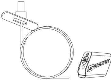
Die Seilabhangung DSAINOXSP 2 mit Queranker und Edelstahl-Universalverschluss dient der Deckenabhangung von Kabelrinnen und Gitterbahnen. Sie besteht aus Edelstahl und ist in Langen von 1000 bis 10000 mm verfugbar. Die maximale Belastung liegt bei 0,44 kN (Grippe Lastklasse 2).
