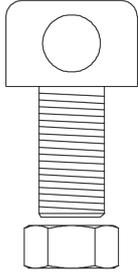
Der Gewindeadapter mit Loch DSAGRIPADAP ist geeignet zur Befestigung an Beleuchtungskörpern, Einschlagankern, Kabelträgersystemen, Profilkammern und anderen Produkten mit einer 6-mm-, 8-mm- oder 10-mm-Bohrung. Er besteht aus galvanisch verzinktem Stahl.
