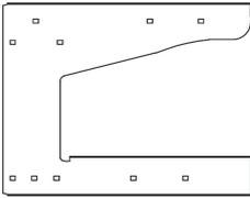
Die Tragkonsole DSAG mit G-Profil dient der Seilabhängung von Kabelrinnen und Gitterbahnen. Sie besteht aus sendzimir-feuerverzinktem Stahl und ist in Breiten von 100 bis 400 mm verfügbar. Die maximale Belastung liegt bei 0,59 kN.
