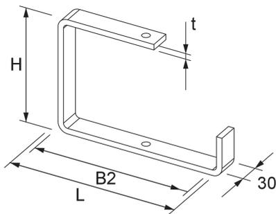
Der flache Deckenbügel DB-FL eignet sich insbesondere zur Abhängung von Gitterbahnen und Kabelrinnen mit Bahnbreiten bis 400 mm. Die Kabelrinne wird mit KLR 6x25, die Gitterbahn mit KLU-L, FRS 6x25 und SEMS 6 befestigt. Verschiedene Materialien und Oberflächen sorgen dafür, dass die Korrosionsanforderungen unterschiedlichster Anwendungsgebiete erfüllt werden. Dieser Artikel ist in sendzimir- oder galvanisch verzinktem Stahl oder Edelstahl mit der Werkstoff-Nr. 1.4571 erhältlich.
