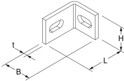
Die Winkellasche BL 5 dient zur Befestigung von Konsolhaltern KHA / KHAL sowie KHU 40/57/60 an der Wand. Der Winkel wird mit dem Konsolhalter verschraubt und an die Betonwand gedübelt. Er besteht aus tauchfeuerverzinktem Stahl.
