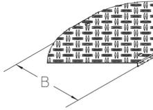
Der variable Bodenkanal-Bogen-Deckel BKVBDR-WZB AL wird auf dem Bodenkanal-Bogen BKVB aufgesetzt und schützt Kabel und Versorgungsleitungen vor Funkenflug und anderen mechanischen Einwirkungen. Er hat eine dem Bogen entsprechende Breite von 100 bis 600 mm. Der Bodenkanal-Bogen-Deckel besteht aus Aluminium-Warzenblech mit Rutschhemmklasse R10. Bei einer maximalen Fachgröße von 200 mm garantieren wir eine geprüfte Belastbarkeit von 3,00 kN nach EN 50085-2-2. Drehriegel sind vormontiert.
